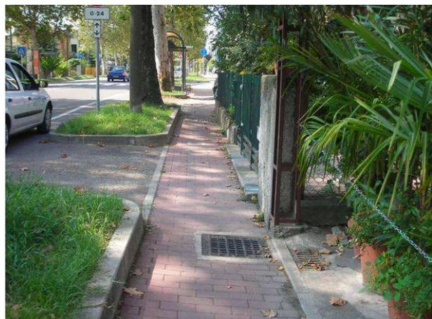
Ma la criticità maggiore si rileva all'incrocio con viale Bosi Maramotti, dove il percorso che proviene da quest'ultima ha una quota superiore, la rampa non è visibile, e il dislivello (scalino) non è né segnalato né protetto.
